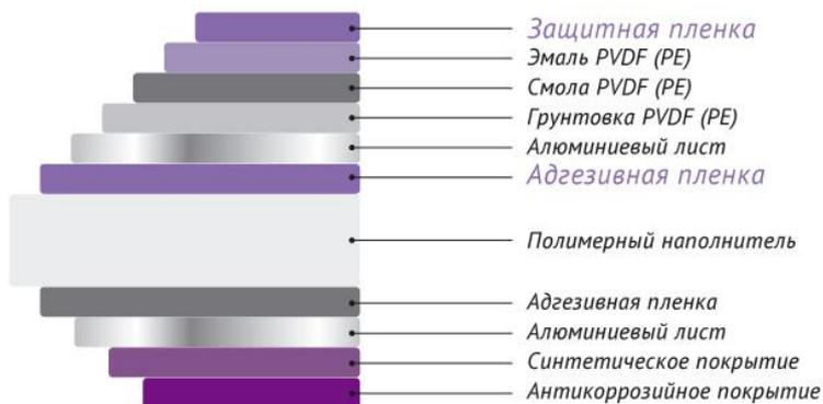
\* В алюминиевых композитных панелях — это совмещение металлического листа с полимерным наполнителем панели.
